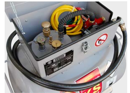
Pumpsåp (KS-MOBIL 200 L) med pump 12V, 25 L/min, ATEX, 4 m utlopps-slang och automatiskt doseringsmunstycke
