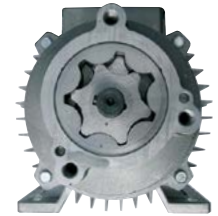
Pumpprincip: växelpump design
