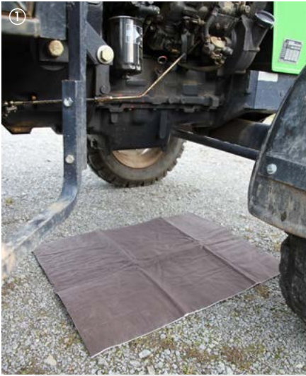
Användning av oljesugmattan från Cemsorb nödset Agrar
