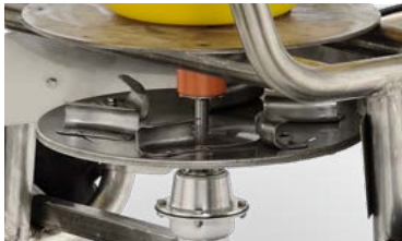
Spridarskiva i rostfritt stål, justerbar
