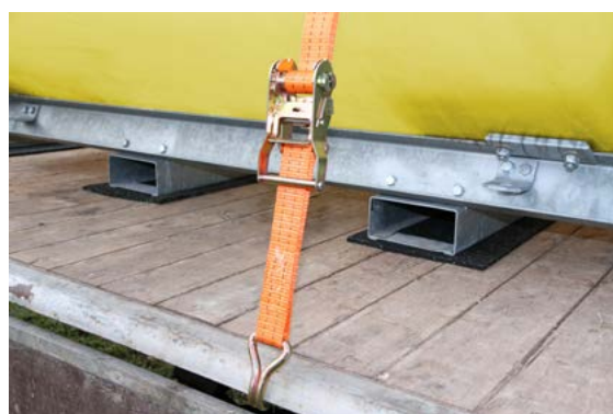
Säkring av laster med halkskyddsmattor och spännband (spänne nedåt) med ett 2000-liters mobilt bevattningsystem som exempel
