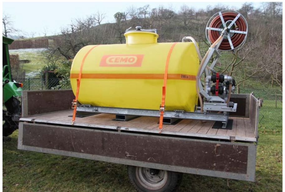
Säkring av laster med halkskyddsmattor och spännband (spänne nedåt) med ett 2000-liters mobilt bevattningsystem som exempel
