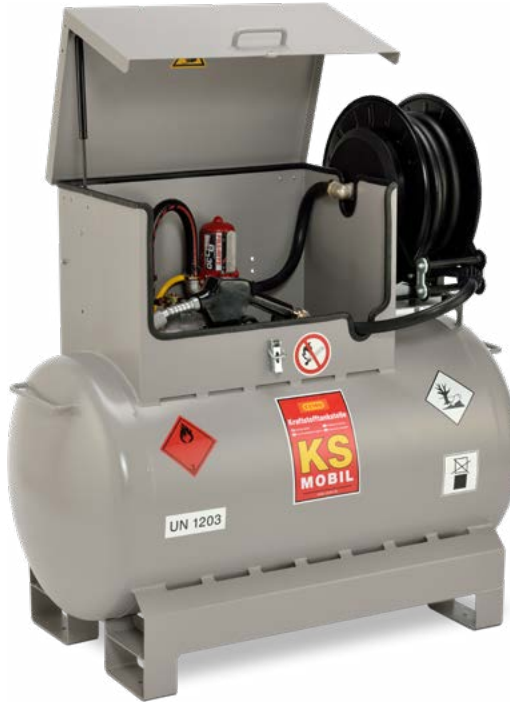
Pumpsåp (KS-MOBIL 300 L) med pump 12V, 25 L/min, ATEX, slangvinda (tillbehör) och automatiskt munstycke
